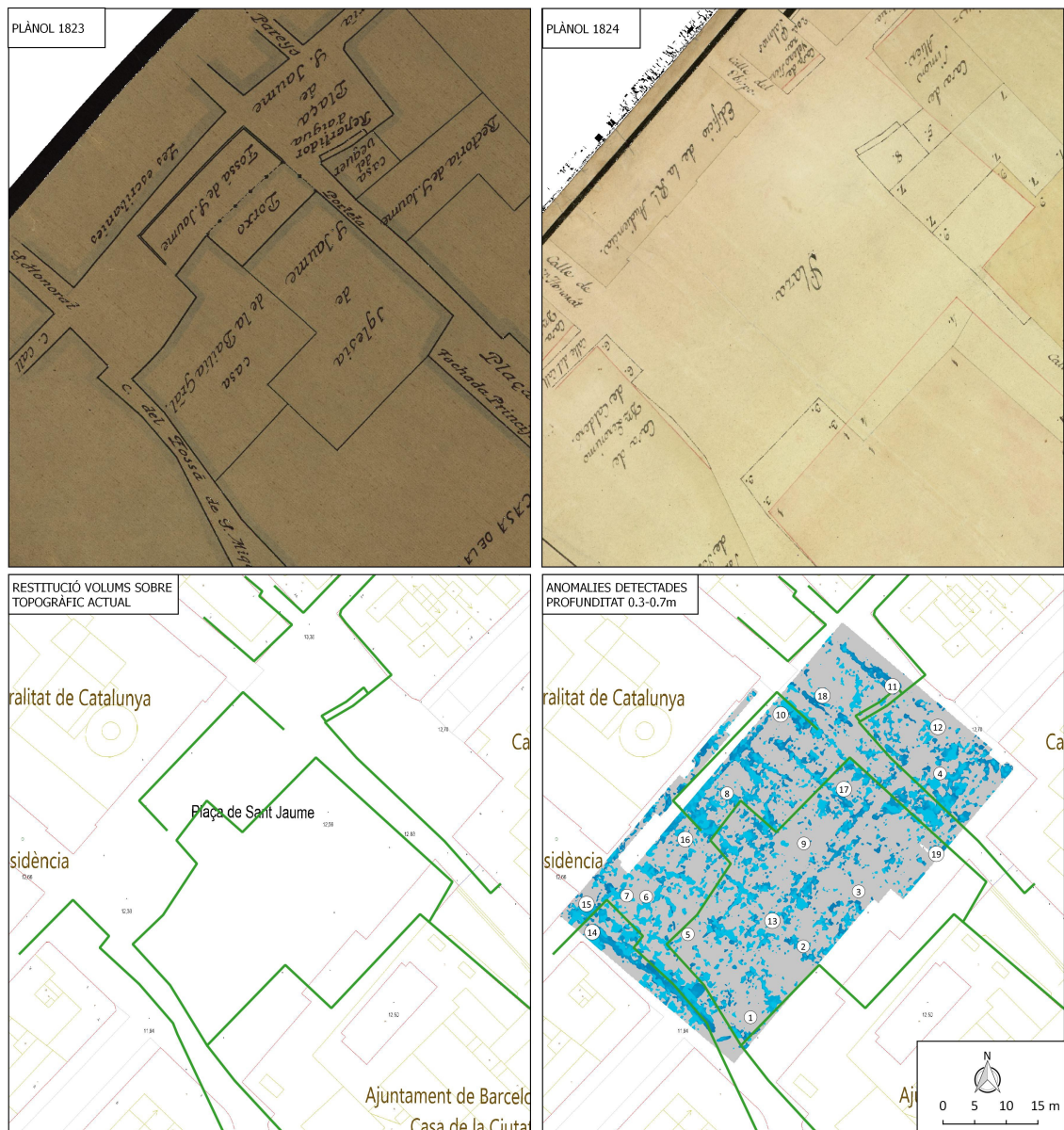
Figura 8: Evolució de la Plaça Sant Jaume. Es mostren els plànols de la dècada de 1820 durant la construcció de la Plaza Constitución. A baix a la dreta es mostren les principals anomalies detectades entre 0.3 i 0.7m de profunditat sobre la referència dels edificis enderrocats.
